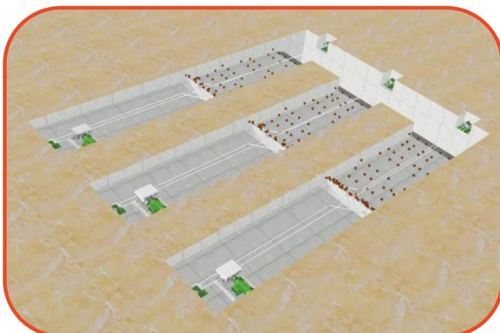
Устройство для удаления навоза оснащено направляющими колесами, которые обеспечивают плавную работу с низким уровнем шума, удаление 90-98% куриного помета и обеспечение чистоты воздуха в курятнике.
