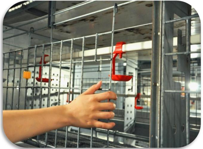
Il y a 2 conduites d'eau avec différentes hauteurs réglables dans chaque étage pour l'abreuvement confortable et pratique. Et toutes les conduites d'eau seront emballées dans des cartons et des sacs en plastique à l'extérieur pour une protection avant expédition.
