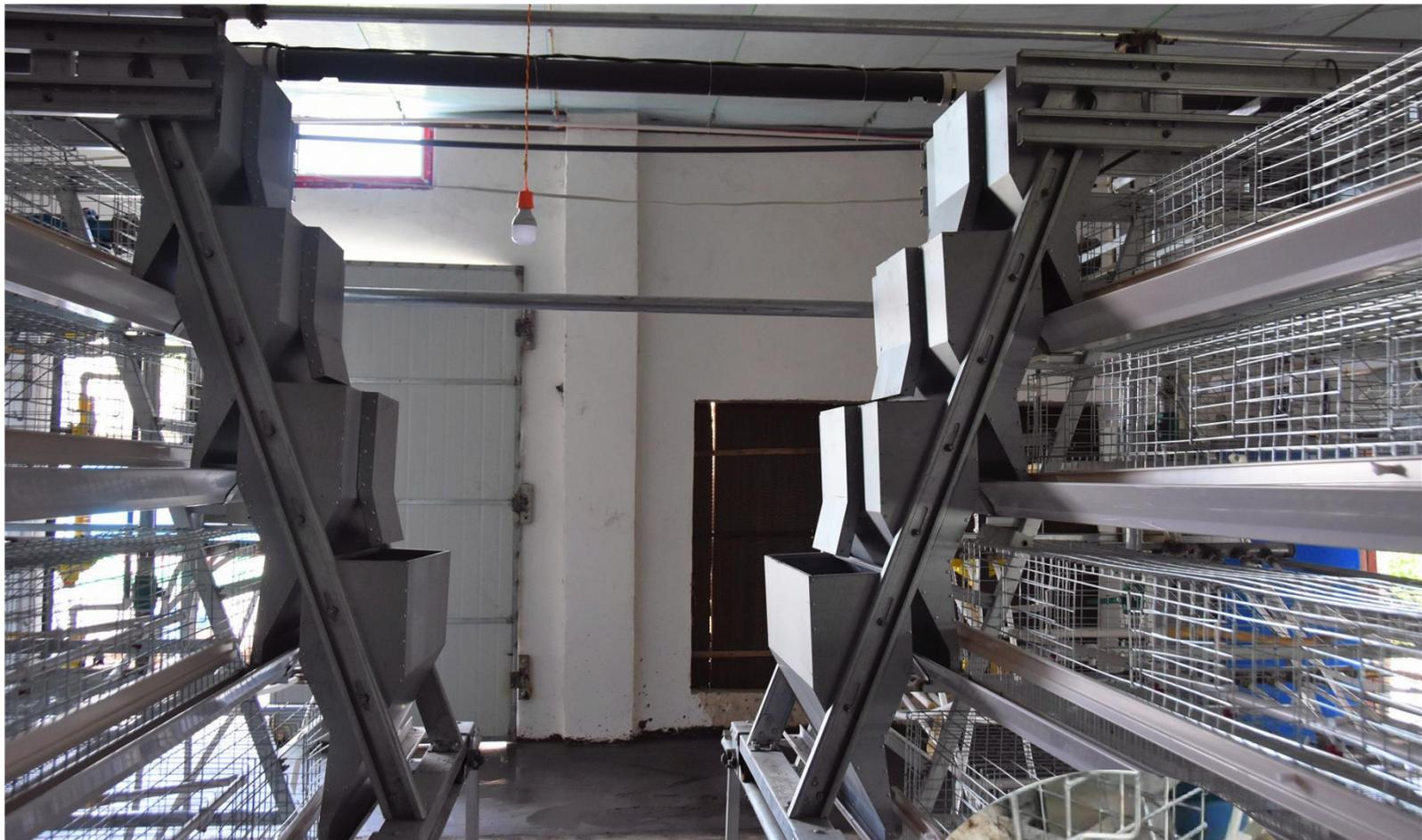
La trémie d'alimentation est reliée par des rivets sans soudure, ce qui la rend plus durable.
