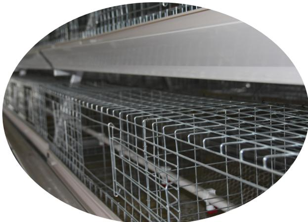
Les grillages et les supports de la cage sont fabriqués en acier galvanisé à chaud, ce qui donne l'avantage aux cages de résister à la corrosion du fumier pendant une longue période, la durée de service peut atteindre plus de 15 ans.
